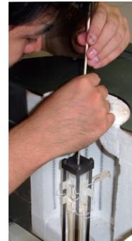
高温型ハニカム燃料電池の構造とそのテスト装置の組み立て（写真）
