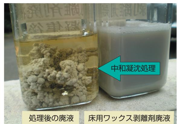
ワックス剥離剤含有廃液の中和凝沈処理
